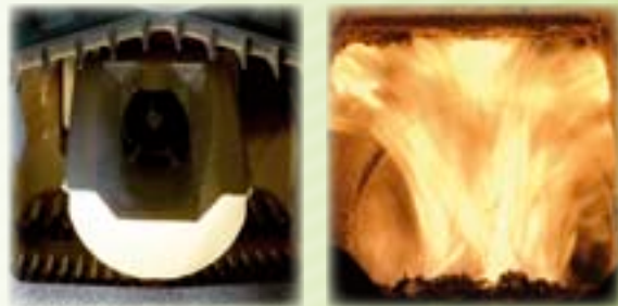
Cámara interior con quemador y detalle funcionamiento
